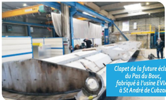
Clapet de la future écluse du Pas du Bouc, fabriqué à l'usine EVIAA à St André de Cubzac
